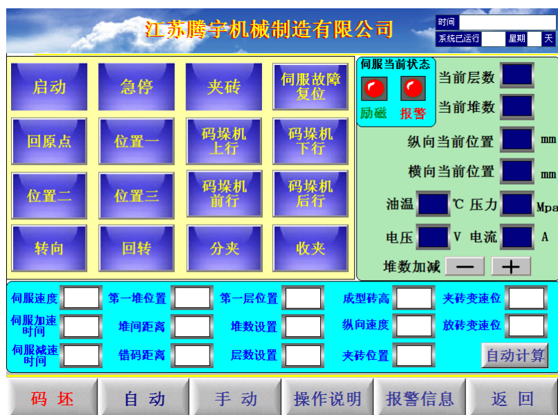
图 7 全自动码坯机系统运行人机界面
